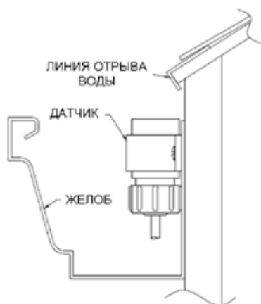
Рис.3. Крепление датчика влажности в желобе
